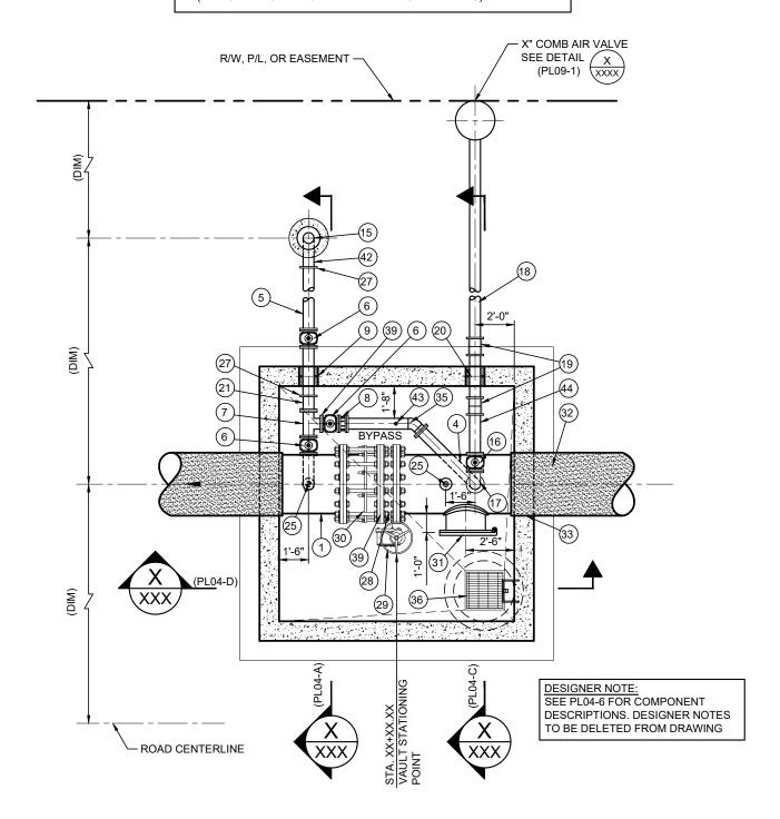
STA. XX+XX.XX PIPING PLAN - DISMANTLING JOINT
